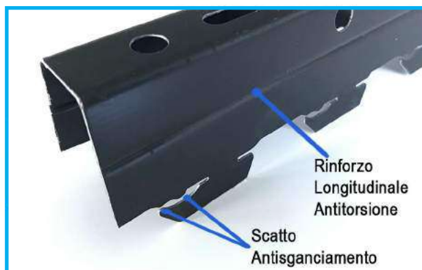
Tipo 43 STRONG ALU - Portante di supporto alluminio preverniciato nero su 2 facce. Spessore mm.10/10 Lunghezza mm.4000 - Fuga aperta passante mm.20-70
