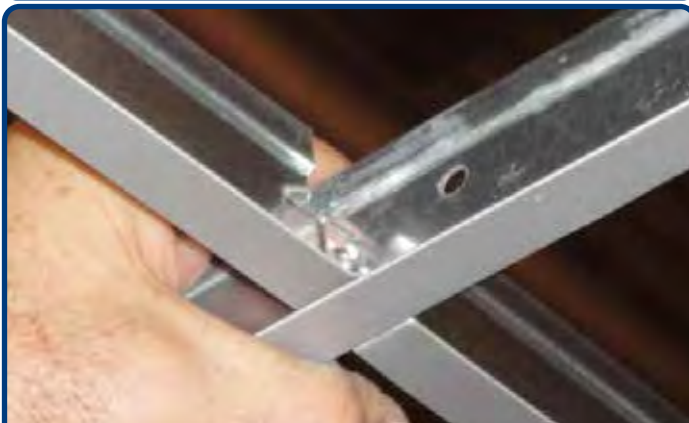
STRUTTURA PORTANTE T Orditura per controsoffitti in appoggio base mm.24 - mm.15 x h38. Corpo unico antiganciamento senza rivetti e linguette riportate. Rivestita in alluminio preverniciato anti ingiallimento resistente umidità e corrosione salsedine.
