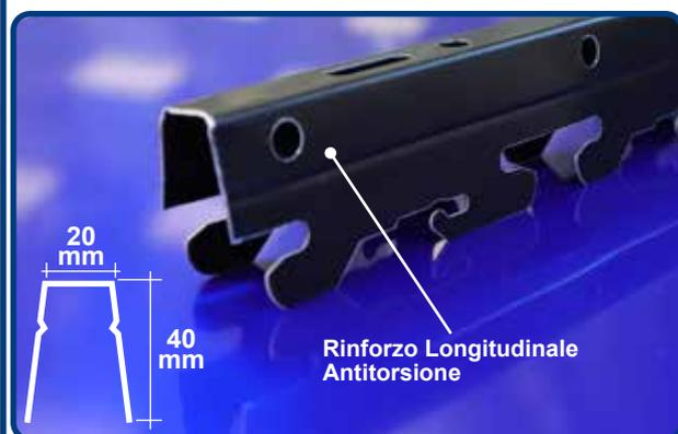
**Tipo 44-01 Omega** Portante di supporto alluminio ed acciaio preverniciato nero su 2 facce - Spessore mm.0,6 - 10/10 Per installazioni all'esterno è suggerito utilizzo di alluminio preverniciato anticorrosione
