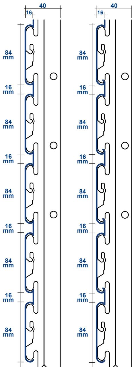
**Tipo 63/Z STRONG** Portante di supporto alluminio ed acciaio preverniciato nero su 2 facce - Spessore mm.0,6 - 10/10 Per installazioni all'esterno è suggerito utilizzo di alluminio preverniciato anticorrosione
