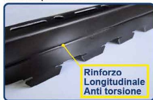
Tipo 43 STRONG Portante di supporto alluminio ed acciaio preverniciato nero su 2 facce Spessore mm.0,6 - 10/10 Per installazioni all'esterno è suggerito utilizzo di alluminio preverniciato anticorrosione
