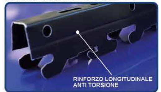
Tipo 63-STRONG Portante di supporto alluminio ed acciaio preverniciato nero su 2 facce Spessore mm.0,6 - 10/10 Per installazioni all'esterno è suggerito utilizzo di alluminio preverniciato anti corrosione
