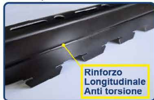
Tipo 43 STRONG Portante di supporto alluminio ed acciaio preverniciato nero su 2 facce Spessore mm.0,6 - 10/10
