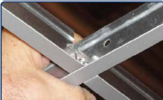
STRUTTURA PORTANTE T Orditura per controsoffitti in appoggio base mm.24 - mm.15 x h38. Corpo unico antigiangiamento senza rivetti e linguette riportate. Rivestita in alluminio preverniciato anti ingiallimento resistente umidità e corrosione salsedine.
