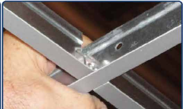
STRUTTURA PORTANTE T Orditura per controsoffitti in appoggio base mm.24 - mm.15 x h38. Corpo unico antisganciamento senza rivetti e linguette riportate. Rivestita in alluminio preverniciato anti ingiallimento resistente umidità e corrosione salsedine.
