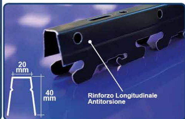
Tipo 63/Z STRONG Portante di supporto alluminio ed acciaio preverniciato nero su 2 facce - Spessore mm.0,6 - 10/10 Per installazioni all'esterno è suggerito utilizzo di alluminio preverniciato anticorrosione
